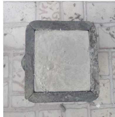
Gambar 2.2 Paving block campuran plastik polypropylene dan pasir
