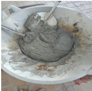
Gambar 2.1. Kondisi setelah pengadukan pasir dan plastik
